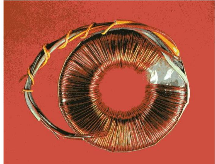
En consecuencia, la salida de un transformador de 15 voltios con un factor de regulación del 10% aumentará 16,5 V cuando no tenga la carga nominal conectada al secundario.
